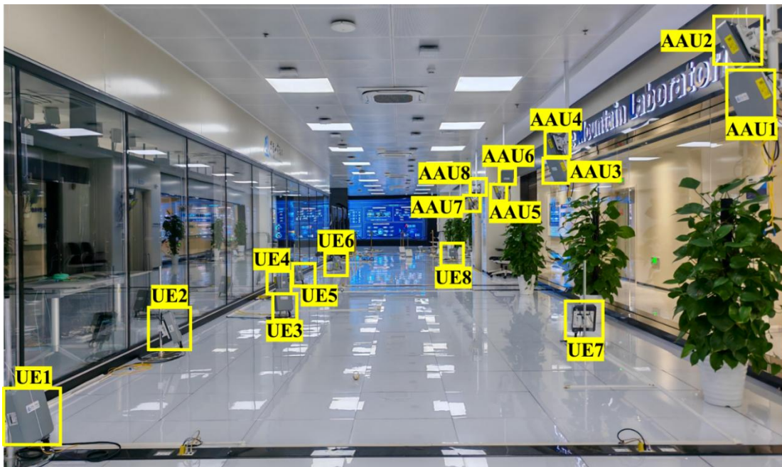
图 5-10 毫米波 CF-RAN 试验系统测试场景
