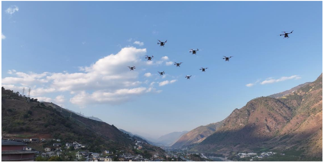
图 5-18 云南省怒江州 10 架多旋翼无人机集群编队飞行
